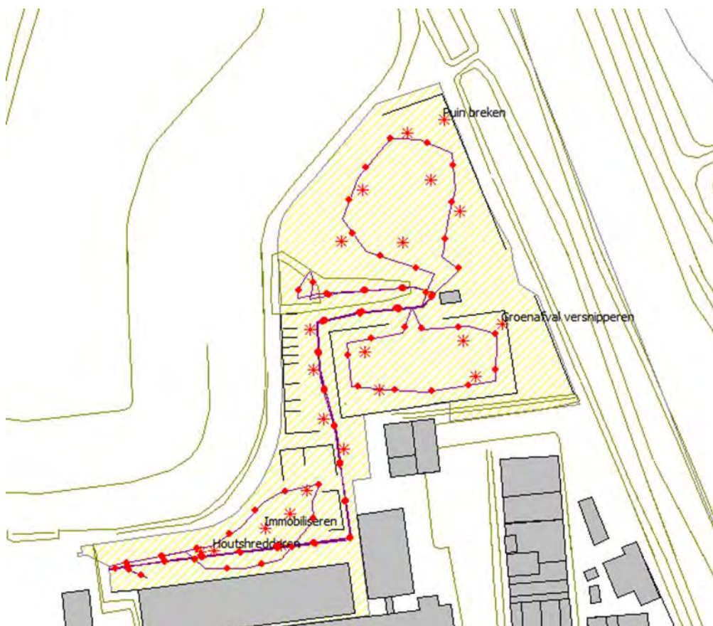
Figuur 3.3 Overzichtsfiguur rekenmodel en globale posities puin breken, groenafval versnipperen, immobiliseren, hout shredderen
